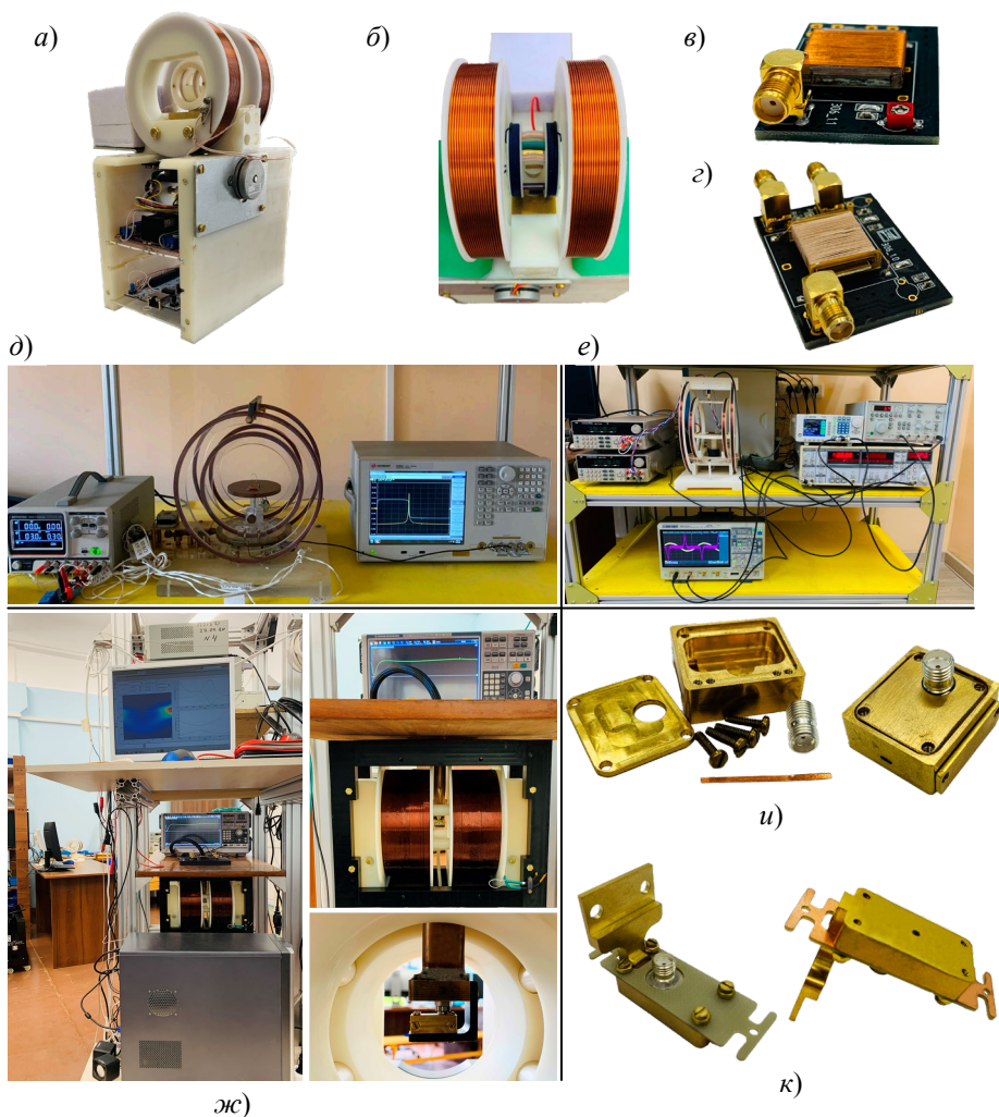
Рисунок 13 – Фотографии разработанных устройств (а, б – спектрометр на основе сверхрегенеративного детектора; в – измерительная ячейка установки (д) для автоматизированного измерения импеданса в ТМП; з – измерительная ячейка установки (е) для наблюдения петель гистерезиса с использованием СД; ж – широкополосный спектрометр ФМР, универсальная (и) и сканирующая (к) измерительные ячейки)
