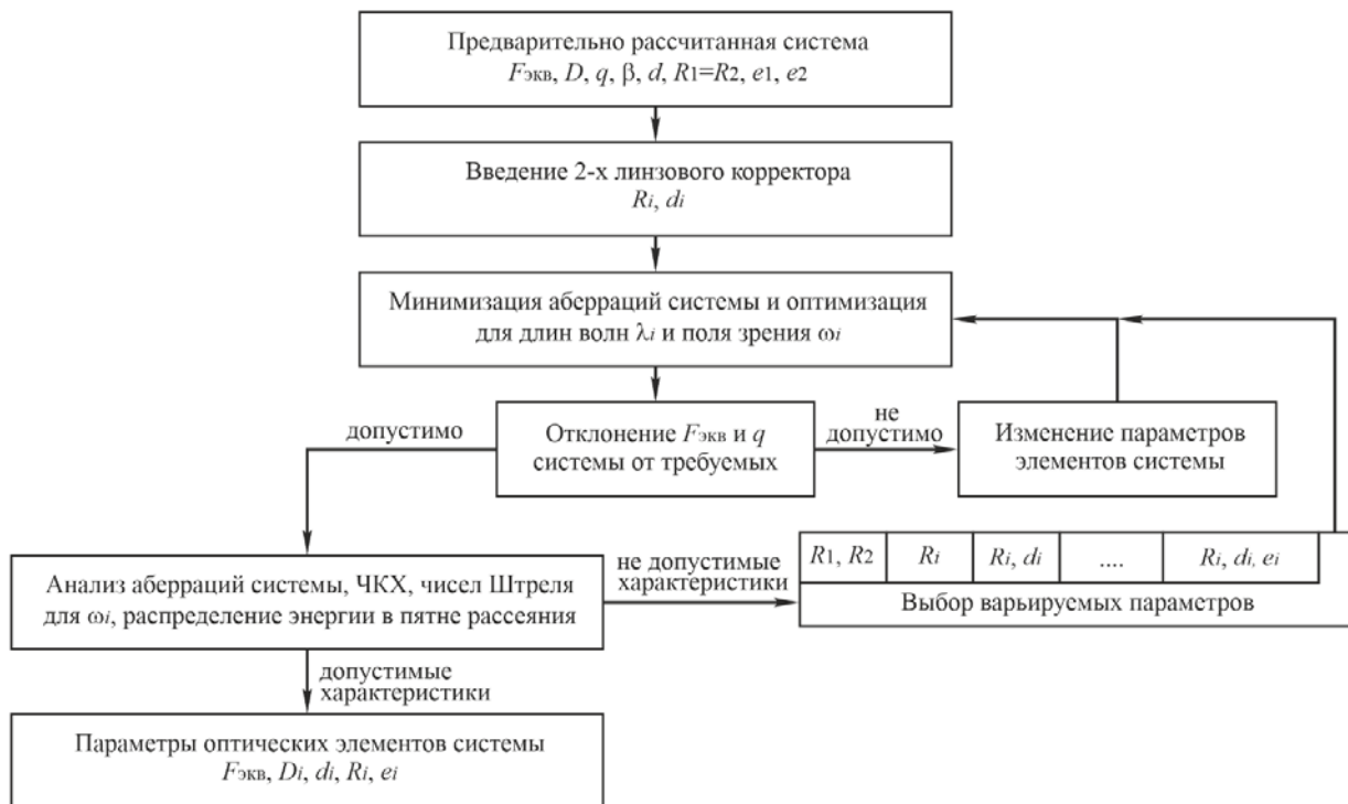
Рисунок 11 – Структурная схема вариативного подхода для оптимизации параметров оптической системы
